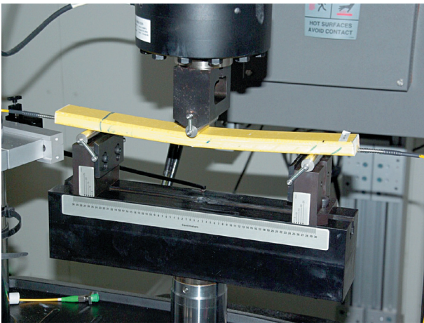
Corps d'épreuve en matériau composite instrumenté à cœur par capteur en fibre optique testé en fatigue, en flexion 3 points à l'Ifsttar.
